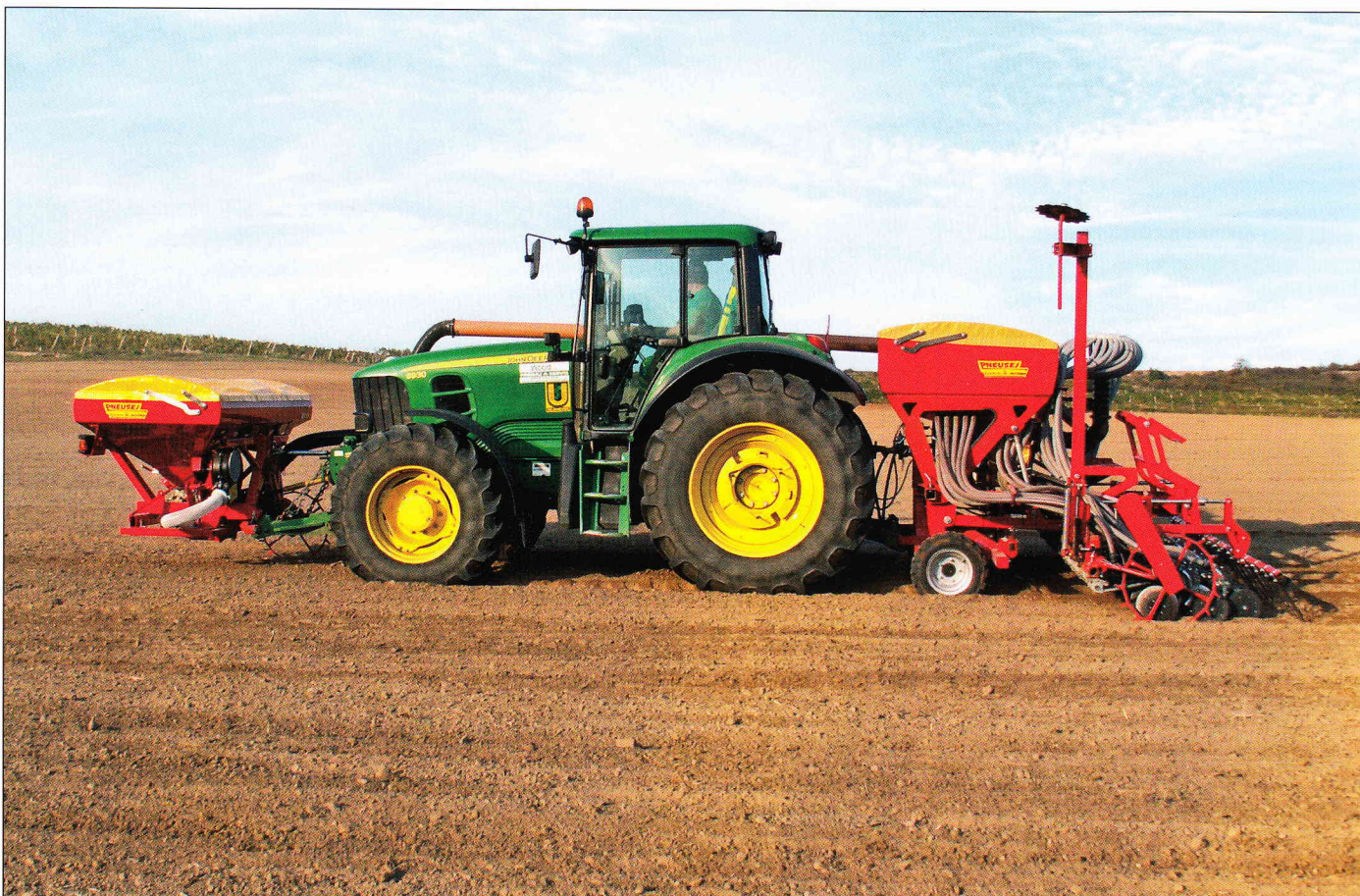
Novinkou s sortimente Pneusej je FT Fert. Zariadenie s čelným zásobníkom montované na sejačky Pneusej dokáže uložiť hnojivo do riadku vysievanej plodiny. Montuje sa na sejačky aj dodatočne.
