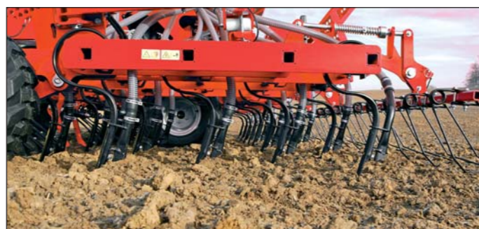
Rozmiestnenie výsevných radličiek RS.
